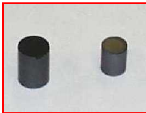
Obr. 5.3 Zmena objemu peletky počas spekania
