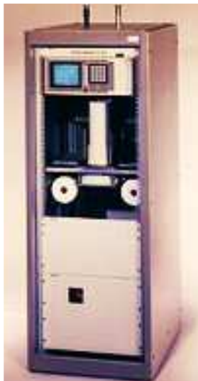
Obr. 4.4 Monitor aerosólov. Vzduch sa presáva cez filtračnú pásku, kde sú aerosóly zachytené. Na detekciu alfa a beta žiarenia sa používa kremíkový detektor typu PIPS alebo scintilačný detektor ZnS+plastik.
