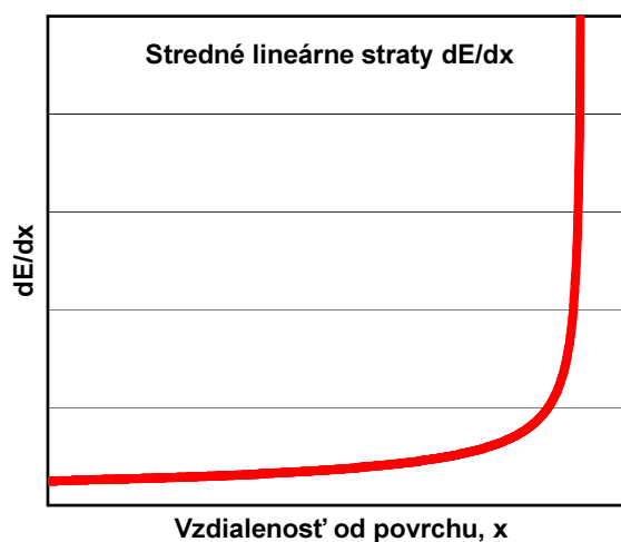
Obr. 1.2 Závislosť stredných lineárnych strát od vzdialenosti od povrchu pri prechode častíc \alpha látkou
