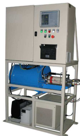
Obr. 4.4 Monitor aerosólov. Vzduch sa presáva cez filtračnú pásku, kde sú aerosóly zachytené. Na detekciu alfa a beta žiarenia sa používa kremíkový detektor typu PIPS alebo scintilačný detektor ZnS+plastik.
