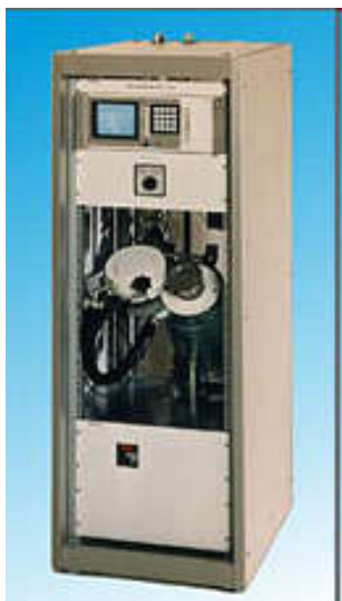
Obr. 4.3 Monitor jódu FHT 1700. Vzduch sa presáva cez marinelliho nádobu, kde je jód zachytávaný na absorbátore, ktorým je nádoba naplnená. Detektorom gama žiarenia je scintilačný kryštál napojený na spektrometrický analyzátor.
