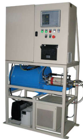
Obr. 4.4 Monitor aerosólov. Vzduch sa presáva cez filtračnú pásku, kde sú aerosóly zachytené. Na detekciu alfa a beta žiarenia sa používa kremíkový detektor typu PIPS alebo scintilačný detektor ZnS+plastik.
