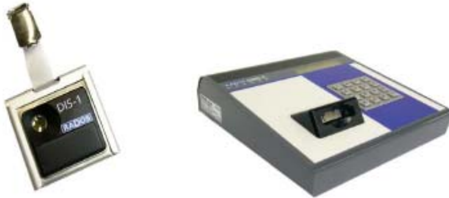
Obr.č.5.3.3.: Pasívny elektronický dozimeter DIS s vyhodnocovacím zariadením
